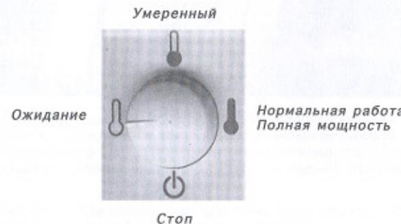
Регулировка температуры в 4 положениях.
